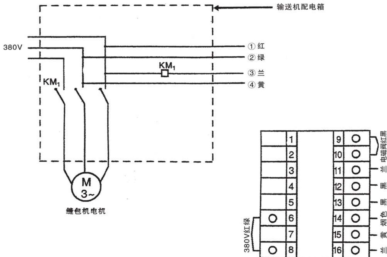
我公司生产的全自动缝包机全自动部分是380V电源下工作
